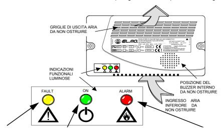
Spia gialla accesa per condizione di Guasto. Spia verde accesa per stato di alimentazione presente. Spia lampeggiante durante lo stato di riscaldamento iniziale del sensore alla prima accensione, durata 2min 30s.
