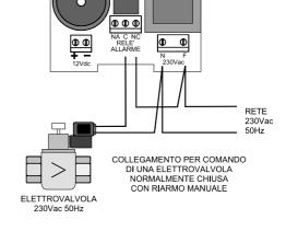
Esempio di collegamento con alimentazione a 12V e valvola normalmente aperta con riarmo manuale. Esempio di collegamento con alimentazione a 12V e valvola normalmente chiusa con riarmo manuale.
