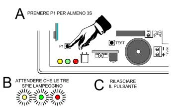
**A** = Con sensore già installato, alimentato, con la spia verde accesa e con il contenitore aperto, premere per almeno 3s il pulsante P1.
