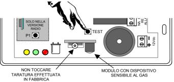
La pressione del tasto provoca l'attivazione delle segnalazioni secondo quanto impostato sul selettore interno accompagnate anche dalle segnalazioni luminose nel pannello frontale. Una volta verificato il buon funzionamento è necessario riarmare l'elettrovalvola eventualmente collegata.
