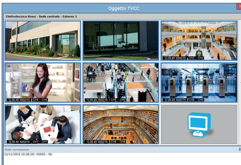
La riga superiore indica la compagnia, il sito e il nome dell'oggetto TVCC riprodotto. La parte inferiore della finestra mostra lo stato della connessione.
