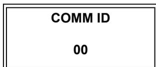
Con questa funzione è possibile visualizzare l'ID corrente del terminale iCON100. Nel caso in cui più terminali iCON100 siano connessi ad un PC principale, ogni unità deve essere configurata con un differente ID di comunicazione.
