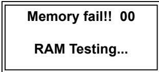
Se la SRAM presenta problemi, il display visualizzerà un messaggio di errore con il numero di blocco della memoria. In questo caso sarà necessario contattare il servizio tecnico.
