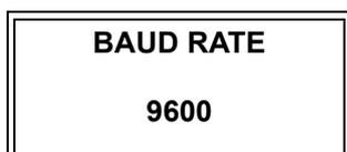
Il valore di baud rate di default è 9600bps. iCON100, comunque, supporta differenti valori: 4800, 19200 e 38400bps. È necessario impostare il medesimo valore di baud rate sia nel terminale, sia nel computer principale.
