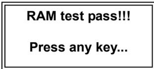
Se la SRAM non presenta problemi, il display visualizzerà un messaggio positivo 'RAM test pass!!!'.
