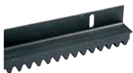
ACG9090 CREMAGLIERA M6 in ferro (sez. 30 x 30 mm) rivestita con CATAFORESI, con angolare 45x45 mm in barre da 2 m al m 84 €
