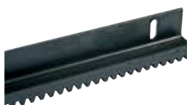
ACS9050 CREMAGLIERA M4 in metallo (sez. 22 x 22 mm) rivestita con CATAFORESI, con angolare 45x30mm (fino a 4000 kg) in barre da 2 m al m 48 €
