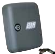
ACJ9086 CASSAFORTE VECOR FLAT da parete (chiave tubolare) IP 54 - con sblocco del freno e spazio per 2 moduli in scatola incasso tipo 502E. 128x150x42
