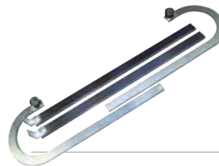
ACG8722 Coppia LEVE CURVE Necessarie quando lo spazio compreso tra il telaio mobile della porta e i cassonetti che contengono i contrappesi è meno di 15 mm.
