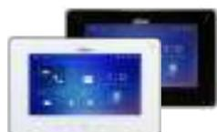
Monitor interno intercomunicante con altre postazioni interne compatibili, finiture bianche/nere, display LCD da 7" risoluzione 1024x600, 1 porta LAN 100 Mbps, Wi-Fi, touch screen capacitivo e tasti touch per funzioni rapide, 6 ingressi e 1 uscita di allarme, funzioni rubrica, registrazione e storico chiamate, pop up su allarme, slot micro SD, montaggio a parete, alimentazione 12 Vdc/PoE <7 W
